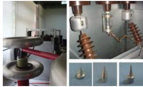
图 2 开关柜局部放电实验平台及 3 种电晕模型
